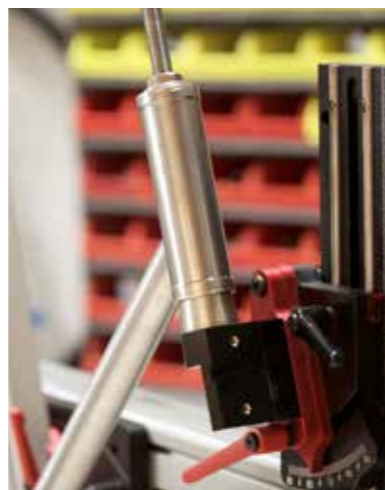
Het frame opbouwen in de jig.
